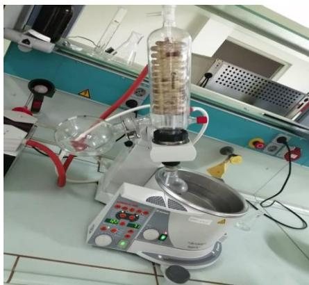
**Figure 12 :** Appareil rota vapeur pour le dosage des huiles et graisses.
