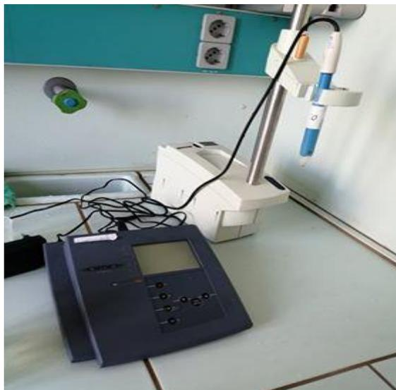
**Figure 08** : pH mètre WTW 720, type InoLab.
