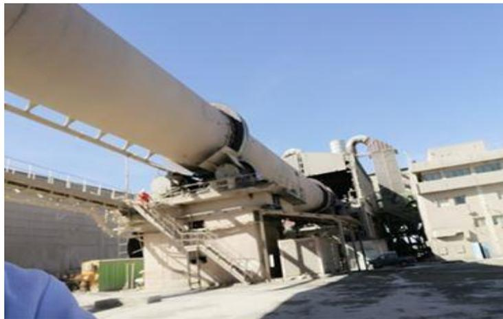
**Figure 05** : Four rotatif de cuisson de la cimenterie Hamma Bouziane
