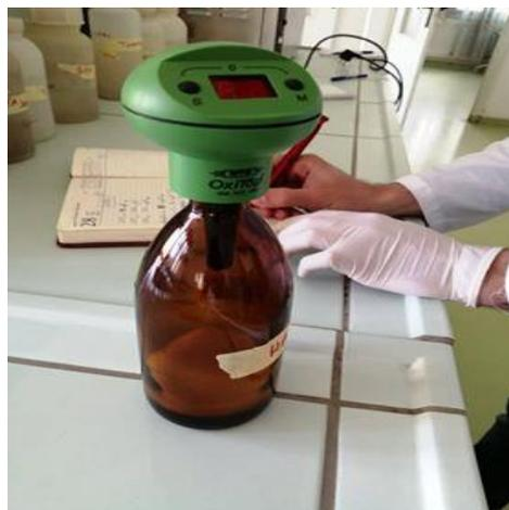
**Figure 10** : DBO mètre OxiTop.
